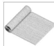
La rete paramassi in filo zincato **PG-ROCKTRAP®** è una rete metallica, fornita in rotoli per ridurre ingombro e spese di trasporto, realizzata con maglia esagonale a doppia torsione, con dimensione caratteristica 8x10 cm. Le dimensioni standard dei rotoli di **PG-ROCKTRAP®** prevedono una lunghezza di 50 m e una larghezza di 2 o 3 m. Sono tuttavia possibili molteplici varianti dimensionali, secondo specifiche esigenze progettuali e costruttive, con larghezza dei rotoli fino a 4 m.
